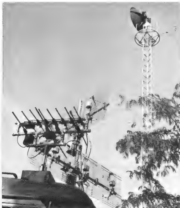
Bild 12. Meßanordnung zur Bestimmung von Reflexionen im Strahlungsfeld; rechts oben: Parabolspiegel mit 1,75 m Durchmesser für 2 GHz. Der Mast dazu besteht aus einzelnen Teilstücken, die von einem Spezialwagen ausgefahren und aufeinander gesteckt werden (Foto: Stumpf)
