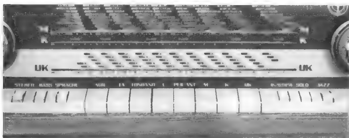
Bild 8. Außer den Einstellern für Höhen und Tiefen enthält das Steuergerät 3004 auch die Klangregistertasten „Solo“, „Jazz“, „Sprache“ und „Baß“
