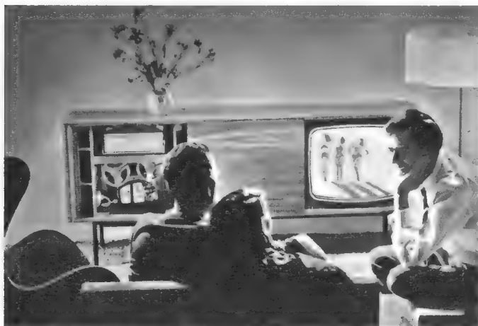
Bild 11. Cinevision, eine Kombination aus Fernsehempfänger (Mitte) und Dia- bzw. Schmalfilmprojektor mit Tonbandgerät (links). Der rechte Bildschirm ist die Projektionsfläche (Telefunken)
