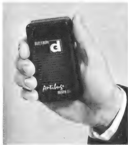
Störsender gegen Lauschmikrofone, serienmäßig fabriziert von einer Firma in Kalifornien
