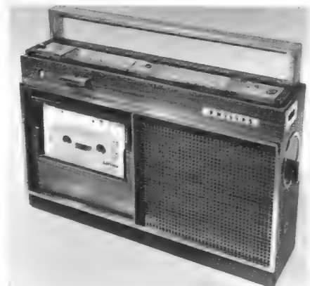
Bild 8. Handmuster eines zukünftigen Philips-Reiseempfängers mit eingebautem Kassettenspieler (Foto: Botzenhardt)
