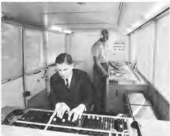
Blick in den Stereo-Übertragungswagen des Süddeutschen Rundfunks. Vorn das Stereo-Misch- und -Steuerpult mit Richtungsreglern und -mischen
